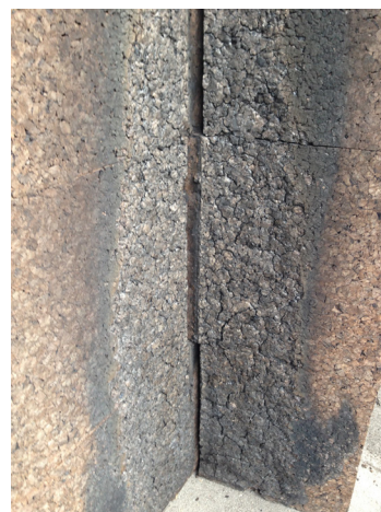
Foto de "canto" de ICB após 30 minutos de exposição a chama directa a cerca de 900^{\circ}\text{C}
